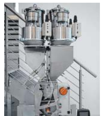
Futuristisch: Eine gravimetrische Dosierstation.
